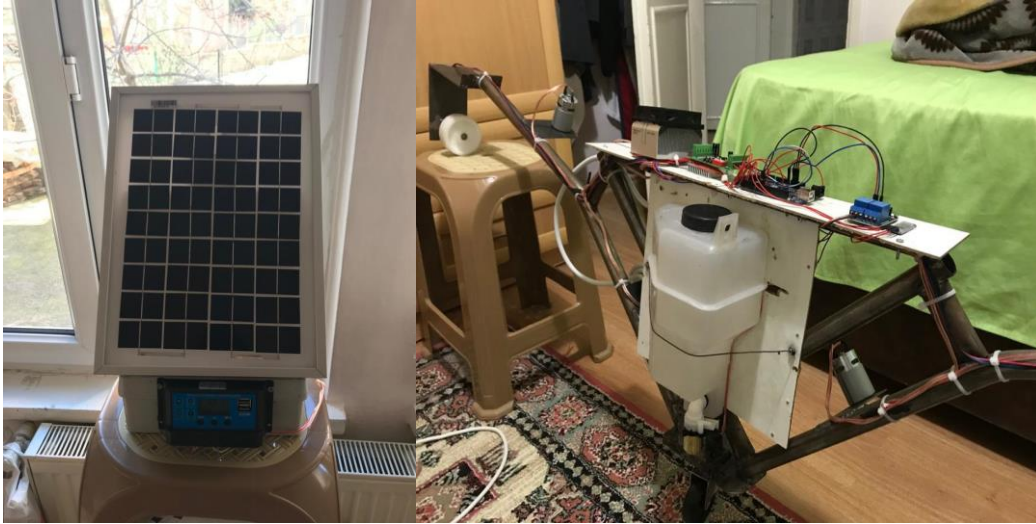
Şekil 1. Tasarlanan sera camı temizleme robotunun şematik görünümü
